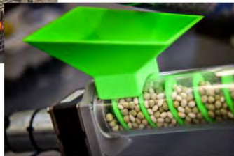
Modell der Biogasanlage mit 3D gedruckten Trichtern und Schneckenförderern
