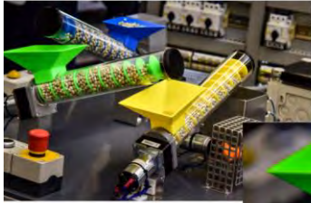
Modell der Biogasanlage mit 3D gedruckten Trichtern und Schneckenförderern
